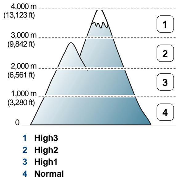
Sie können die Höhe über dem Meeresspiegel einstellen, indem Sie im Samsung Easy Printer Manager unter **Geräteeinstellungen** oder im Programm Printer Settings Utility unter **Machine** die entsprechende Angabe vornehmen.
